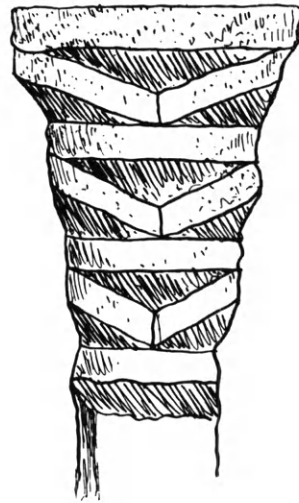
Εἰκ. 250. Προοπτικὴ ἀποψὶς τῆς ἡμιφατνωματικῆς ὀροφῆς τοῦ ὀρύγματος τῆς ἐν Τήνῳ κρήνης.
