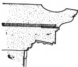
Εἰκ. 13. Ἐνίσχυσις διὰ σιδερώδων ράβδων τῶν παρατείδων τοῦ ναοῦ τῶν Διοσκούρων τοῦ Ἀκράγαντος
