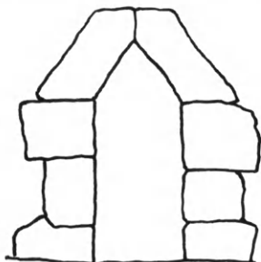
Εἰκ. 330. Τομή τοῦ ἐν Σάμφ Εὐπαλινείου ὑδραγωγείου. (Fabricius)
