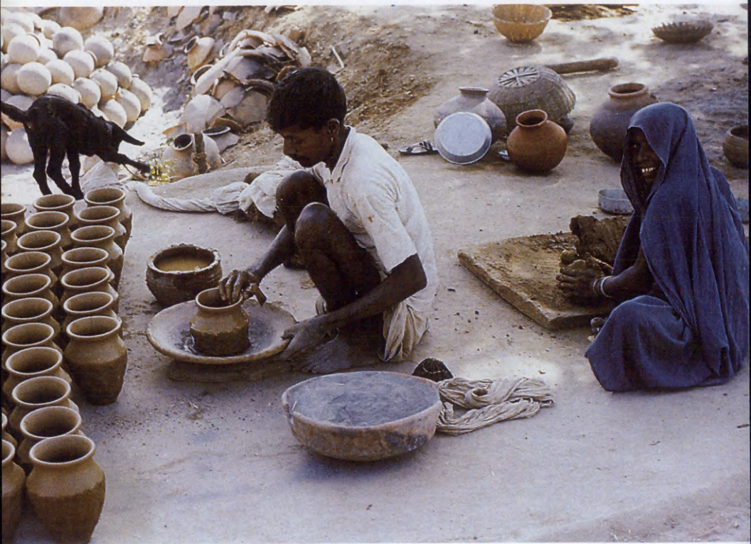
11. Ἐργαστήριο χειροποίητης κεραμικῆς ἔξω ἀπὸ τὸ Kazuraho στὴν Ἰνδία. Δεξιὰ ἡ τελικὴ μάλαξη τοῦ πηλοῦ. Ἀριστερὰ ἡ κατασκευὴ τοῦ ἀγγείου.
